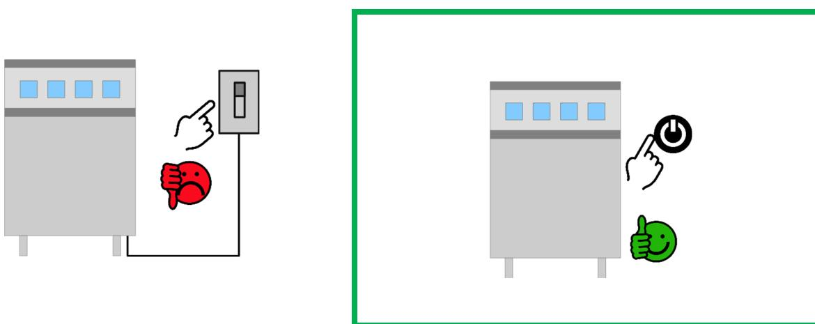
Le macchine elettroniche devono essere spente attraverso il comando sul display. In questo modo si garantisce la disponibilità della ventilazione di raffrescamento fino a smaltimento del calore residuo.
